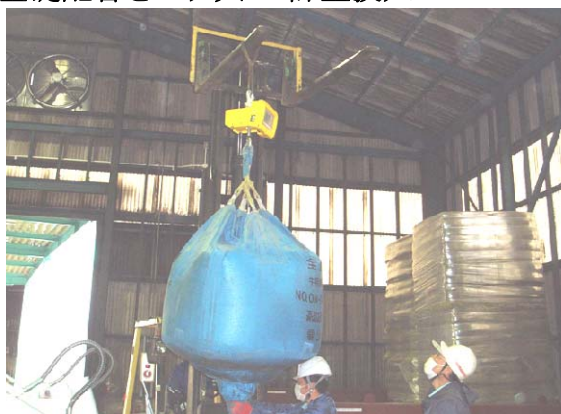
3) 基礎配合をバケットへ計量投入
